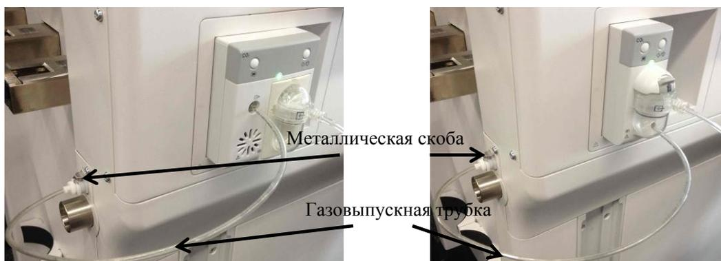
Для удаления проб газа в систему утилизации отработанных газов нажмите на металлическую скобу, затем вставьте газоотводную трубку в отверстие возврата пробы
