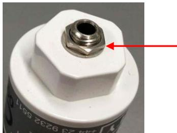
1. Вверните датчик  $O_2$  в корпус датчика  $O_2$ . Затем закрепите кабель датчика  $O_2$  в корпусе датчика  $O_2$ .
