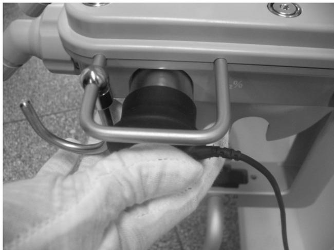
3. Вставьте другой конец кабеля датчика O<sub>2</sub> в разъем датчика O<sub>2</sub> на адаптере контура.
