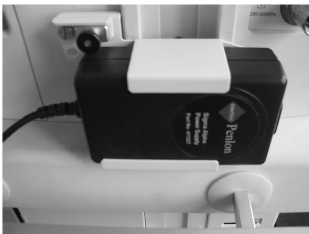
◆ Оттянув планку ручного фиксатора, поверните ее против часовой стрелки на 270 градусов и отпустите, чтобы зафиксировать адаптер в держателе.
