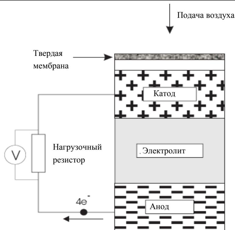
На катоде кислород распадается на гидроксильные ионы согласно следующей формуле:
