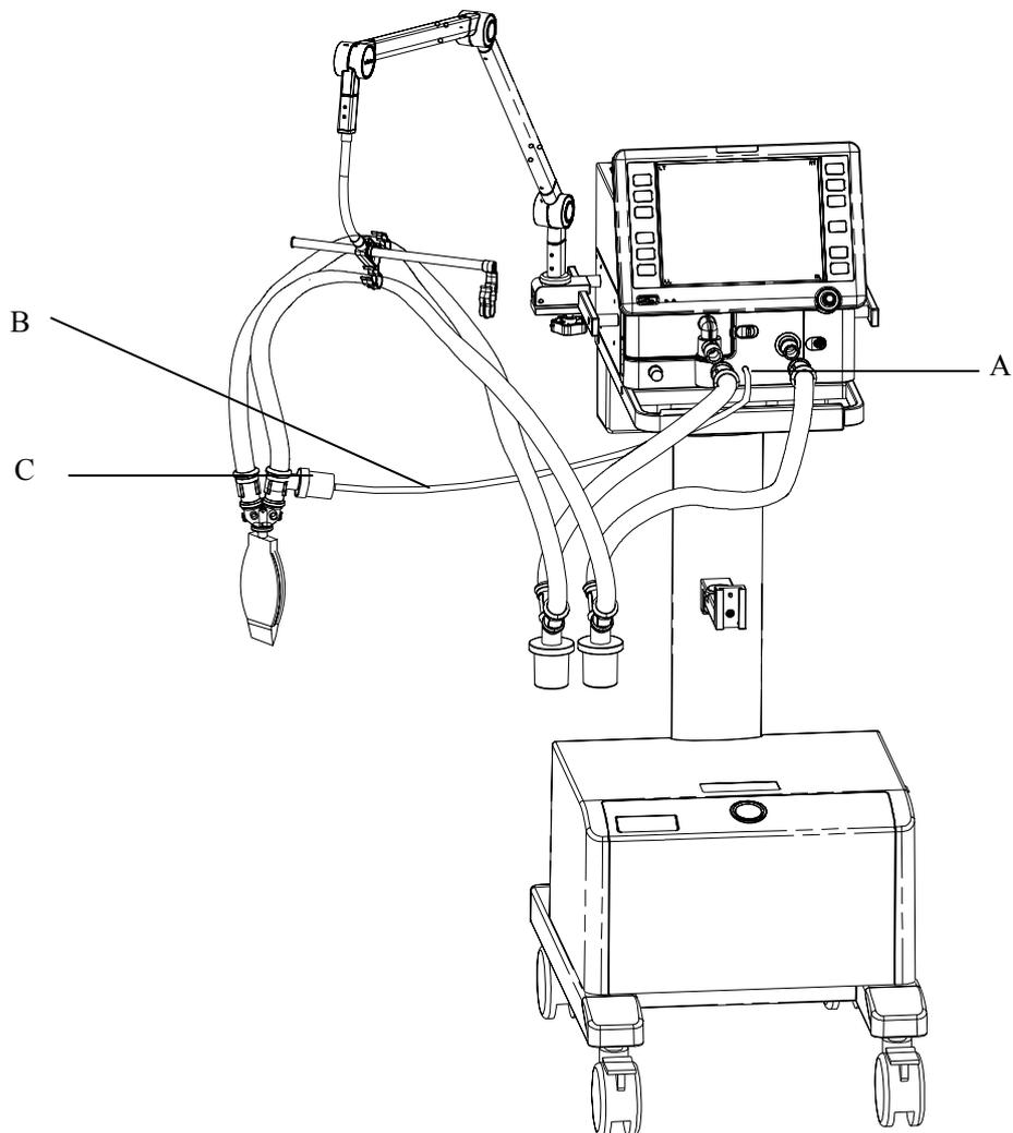
A. Разъем ингалятора    B. Трубка ингалятора    C. Ингалятор
