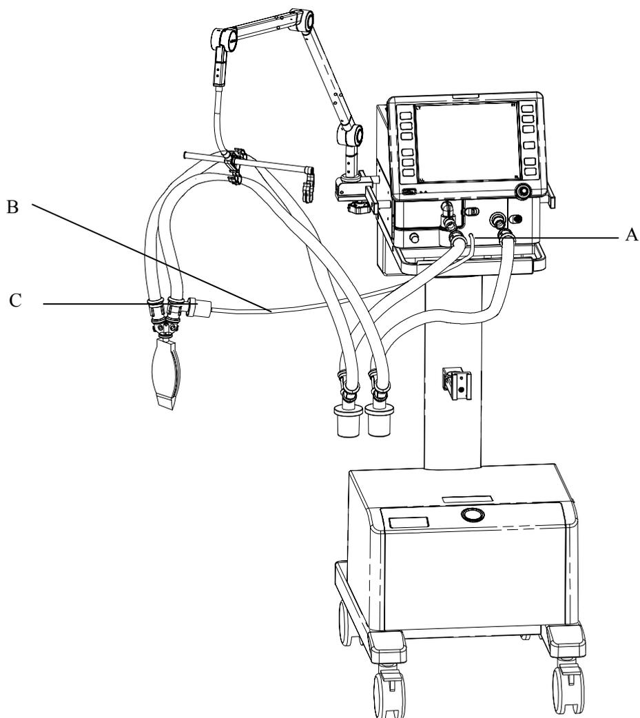
A. Соединитель ингалятора      В. Трубка ингалятора      С. Ингалятор
