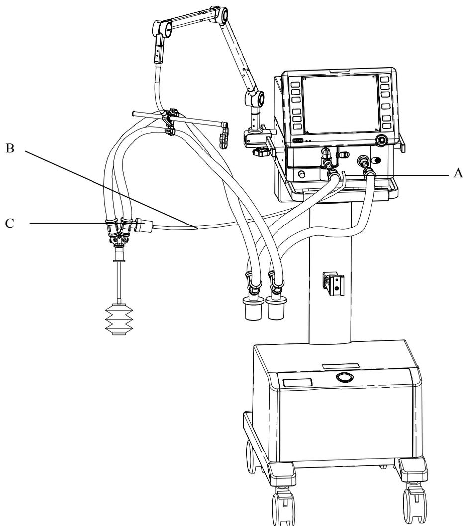
A. Разъем ингалятора    B. Трубка ингалятора    C. Ингалятор
