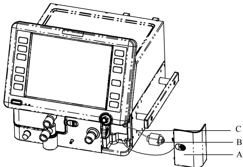
A. Крышка датчика O2    B. Датчик O2    C. Соединительная линия датчика O2
